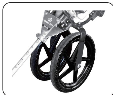
②車輪ステー内側への車輪取付
